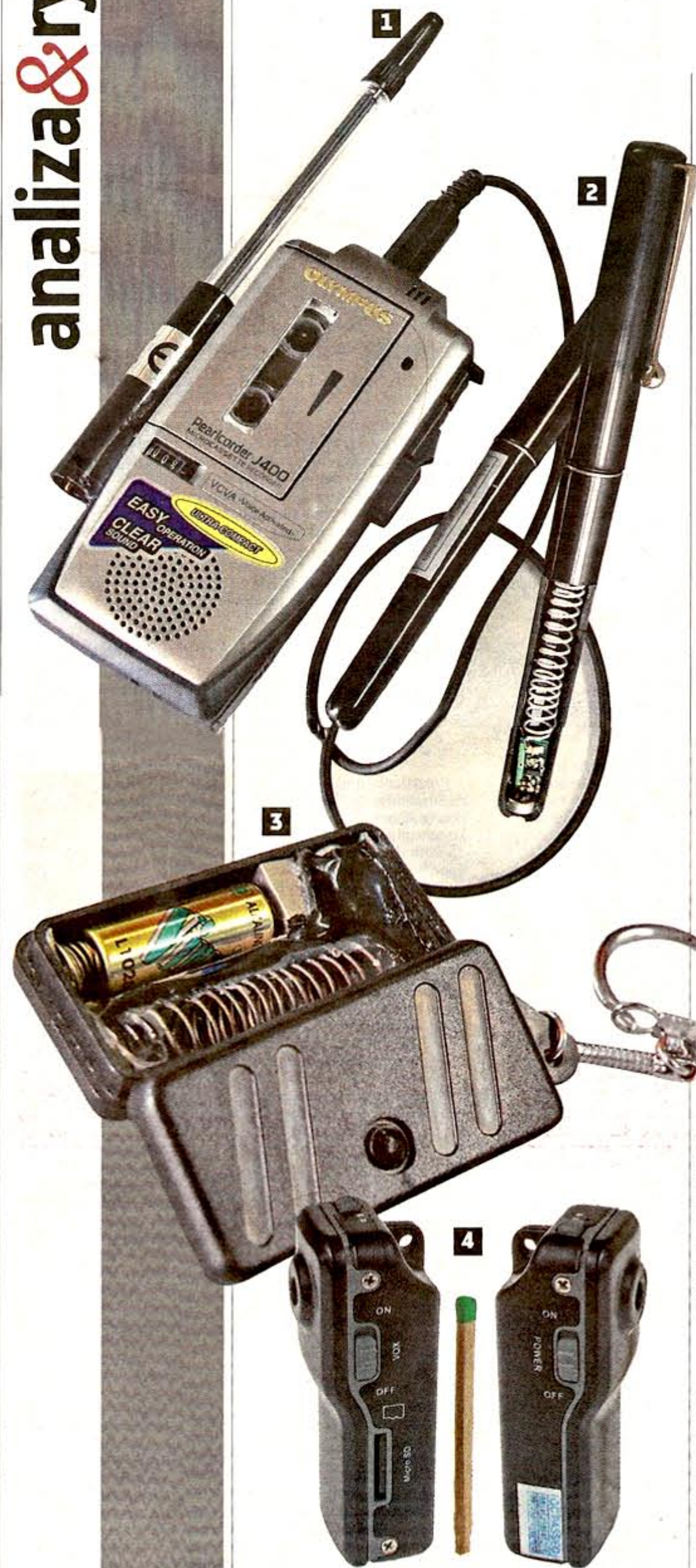
Urządzenie podsłuchowe z możliwością nagrywania (1), urządzenie podsłuchowe zamontowane w długopisie (2) oraz breloku (3) i mikrokamera z dyktafonem (4). FOT. W. WASYLUK
